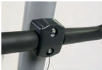
8. Прикрепите поручень (№6) к верхней трубке (№4) с помощью 2 пружинных шайб (№9) и 2 винтов M8x25 (№45). Зафиксируйте шестигранным ключом (№52). Установите пластиковую крышку на кронштейн поручня (№46).
