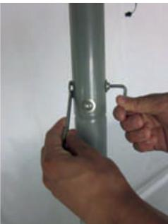
7. Прикрепите верхнюю трубку (№4) к нижней трубке (№5) с помощью дуговых шайб (№49) и 2 винтов M8x25 (№43), гайки M8 (№47) и 1 болта (№8). Зафиксируйте шестигранным ключом (№52) и гаечным ключом (№53).
