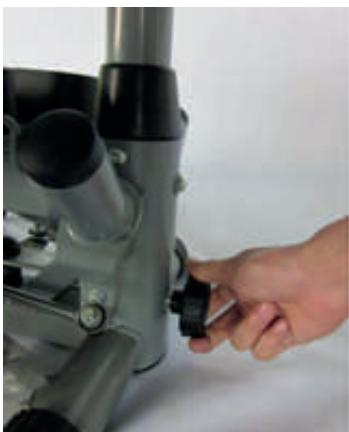
5. Прикрепите ручку (№14) к основанию (№1). Натяжение регулируется с помощью этой ручки (№14). Поверните ручку по часовой стрелке для увеличения натяжения и против часовой стрелки для уменьшения натяжения.
