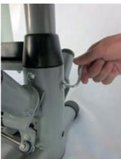
4. Вставьте нижнюю трубку (№5) в основание (№1), закрепите с помощью 4 дуговых шайб (№49) и 4 винтов M8x25 (№43). Зафиксируйте шестигранным ключом (№52).
